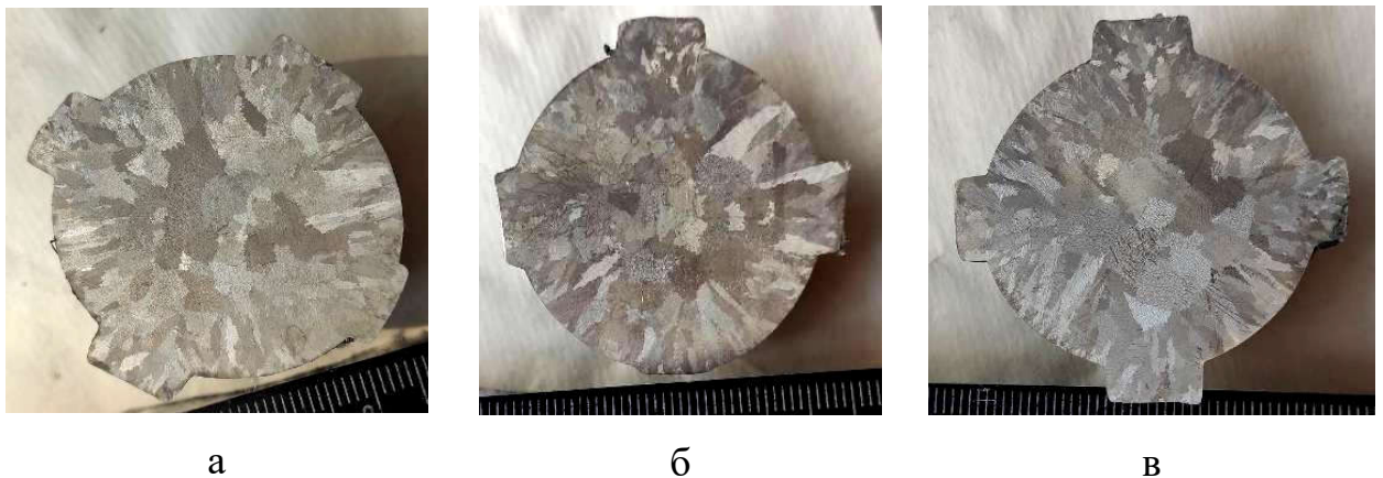
Рис. 5.23 – Макроструктура у поперечному перерізі фрагментів блоку зразків із комплексно модифікованого сплаву ЖСЗДК-ВІ дослідних варіантів: а – 1; б – 2; в – 3.
