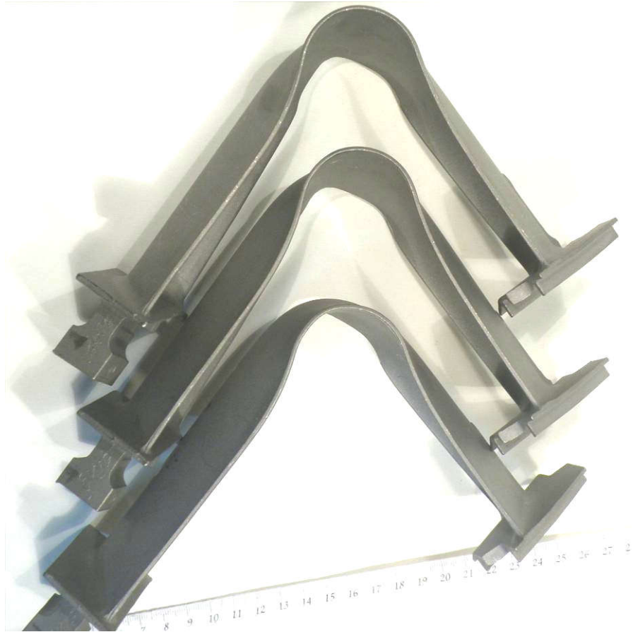
Рис. 5.9 – Зовнішній вигляд робочих лопаток із сплаву ЖСЗДК-ВІ, модифікованого нікелево-ітрієвою лігатурою, після ГПІ та стандартної ТО, після випробування на згин.
