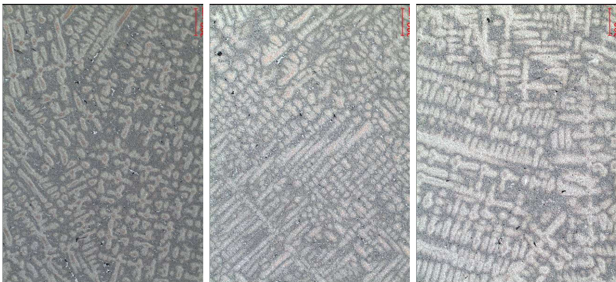
Рис. 5.13 – Мікроструктура в трьох перерізах пера робочої лопатки в литому стані, \times 50 : а – «I-I»; б – «II-II»; в – «III-III».
