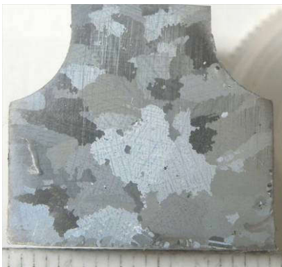
Рис. 5.2 – Макроструктура у поперечному перерізі хвостовика (а) та пера (б) робочої лопатки після ГП та стандартної термообробки.
