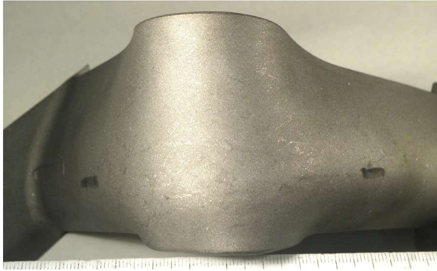
Рис. 5.10 – Зовнішній вигляд зони згину на робочій лопатці (кут згину 115^\circ ) після випробування (ІТН-1 + ГП + стандартна термообробка).
