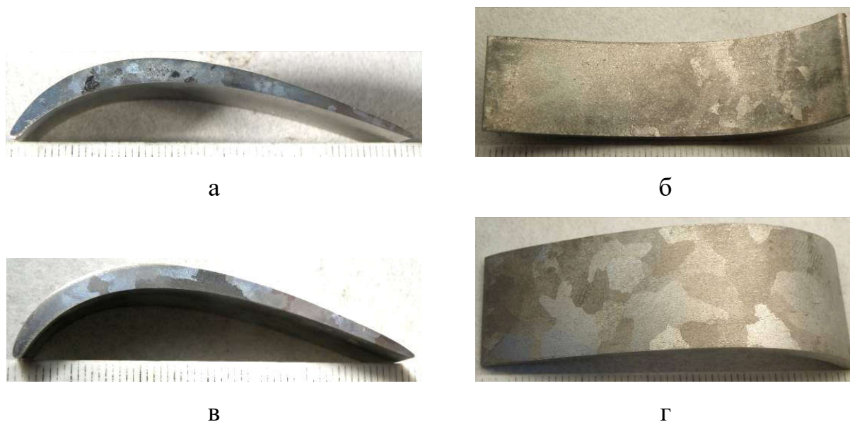
Рис. 4.2 – Макроструктура в поперечному перерізі (а, в) та на поверхні пера (б, г) лопаток після випробування на згин.
