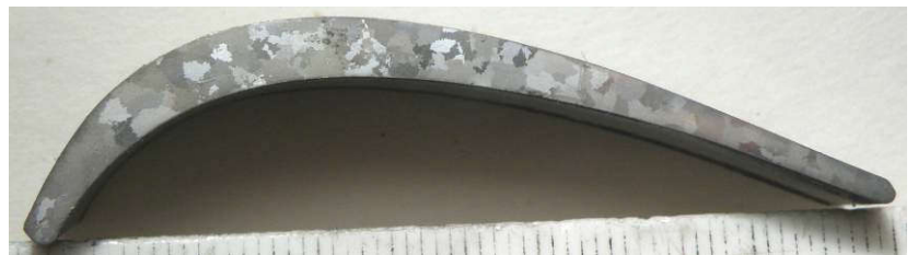
Рис. 5.2 – Макроструктура у поперечному перерізі хвостовика (а) та пера (б) робочої лопатки після ГП та стандартної термообробки.
