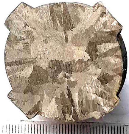
Рис. 5.19 – Типова макроструктура фрагменту у поперечному перерізі досліджених зразків із комплексно модифікованого сплаву ЖСДК-ВІ.
