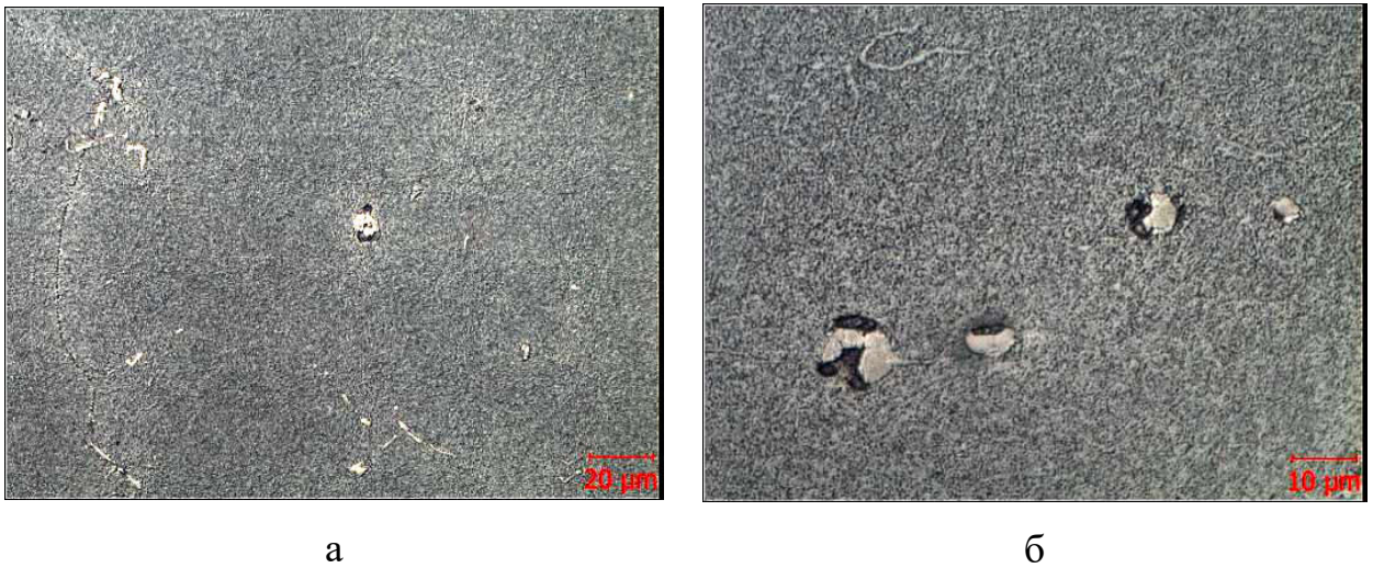
Рис. 5.27 – Оплавлення евтектичної ( \gamma - \gamma' )-фази у зразках з комплексно модифікованого сплаву ЖСЗДК-ВІ, відлитих за варіантом 3.
