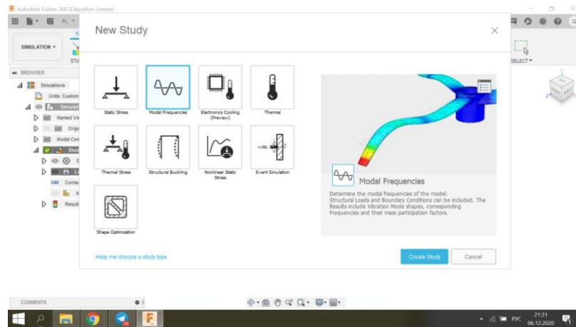
Рисунок 4.5 - Створення дослідження дії вібрації на роботу блоку бортової радіоелектронної апаратури із наявних елементів
