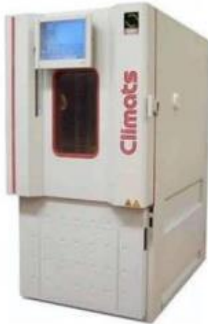
Рисунок 3.1 - Камера «EXCAL» класу холод/тепло
