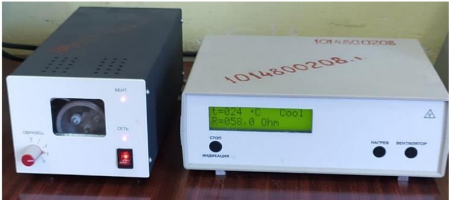
Рисунок 1 – Фотографія дослідної установки для дослідження температурної залежності електропровідності твердих тіл
