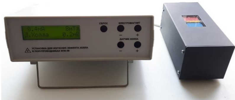
Рисунок 2 – Фотографія дослідної установки для дослідження ефекту Холла
