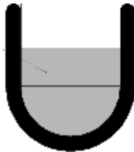
Рисунок 2.7 - Поперечний перетин деформованої жолобком стрічки після заповнення шихтою
