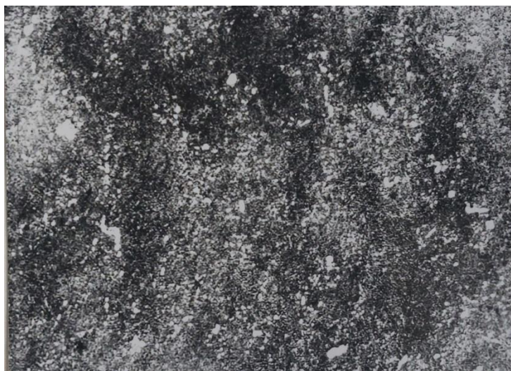
Рисунок 3.5 - Мікроструктура сталі 4Х3Н3Г6М7Ф після відпалу за режимом: 680 °С, витримка 6 годин, охолодження з піччю; х 800
