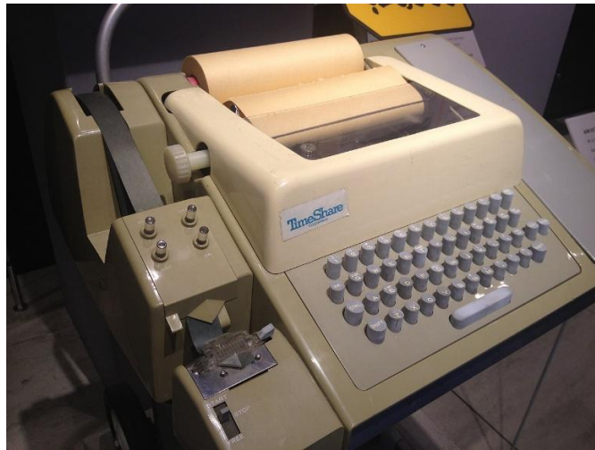
Рисунок 1.1 – Телетайп Model 33 ASR[1]
