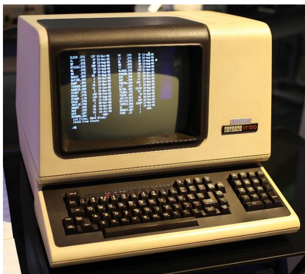
Рисунок 1.2 – Вигляд текстового комп'ютерного термінала VT100[3]
