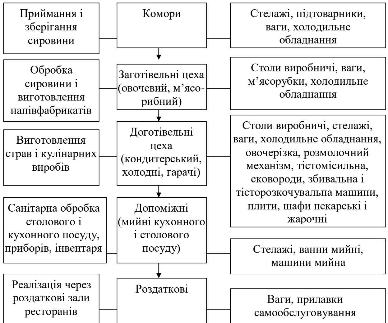
Рис. 2.3 – Схема виробничого процесу ресторану «Bella Vita»
