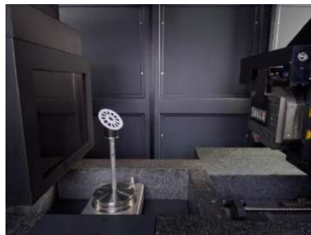
Рисунок 3.4 - Приклад вимірювання зубчастих коліс на томографі
