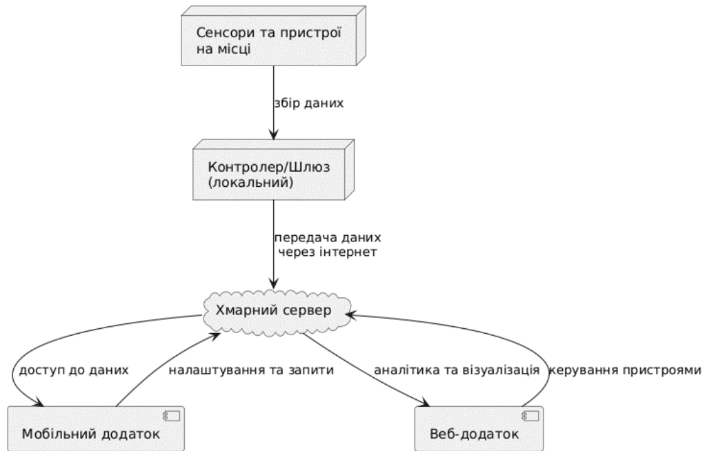
Рисунок 1.4 - Централізована архітектура з використанням хмарного сервера [20]
