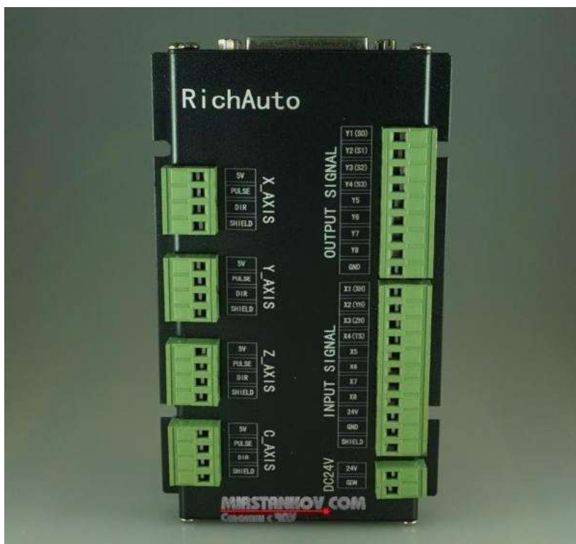
Рисунок 1.6 – RichAuto A11 плата розв'язки
