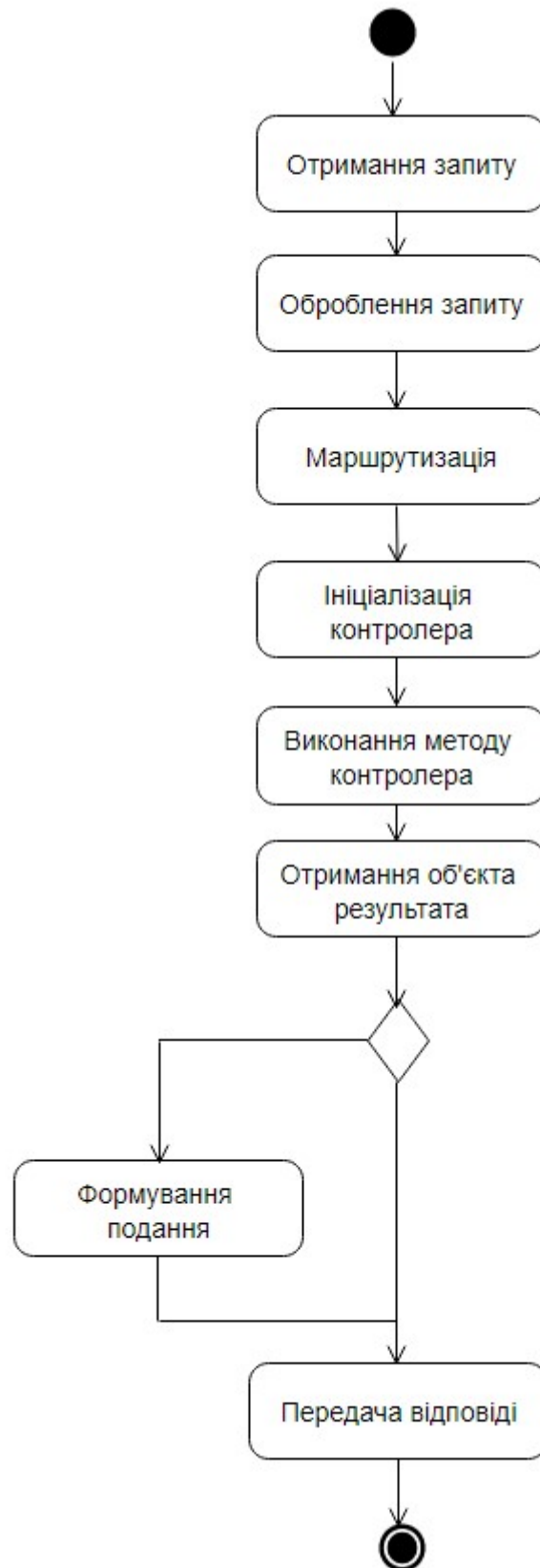
Рисунок 3.1 – Життєвий цикл запиту в ASP.NET-застосунку
