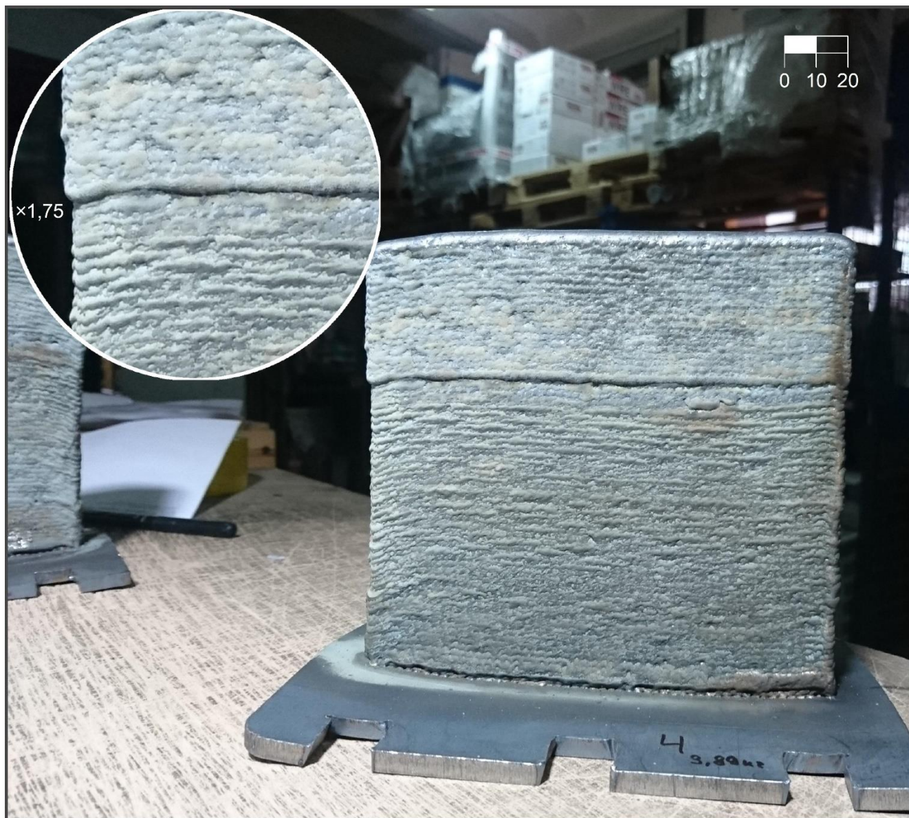
Рисунок 1.5 – Дефект зсуву геометрії вирощуваної деталі після заміни контактного наконечника
