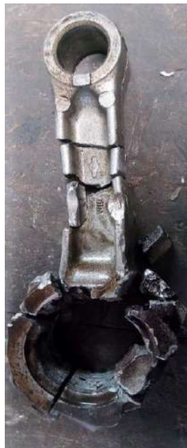
Рисунок 1.4—Руйнування шатуна при гідроударі.
