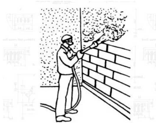
Рисунок 3.18 - Послідовне нанесення шарів обризку, грунту
