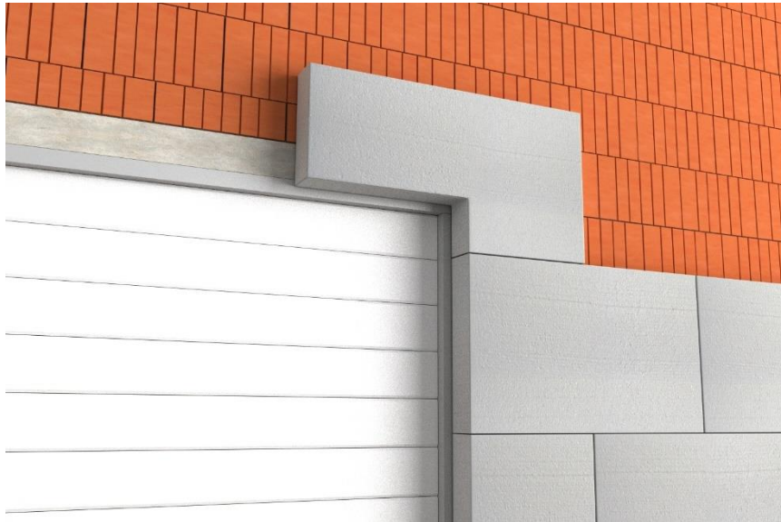
Рисунок 6.8 – Приклеювання пінополістиролу на стіни
