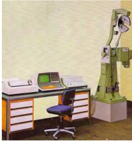
Рисунок 2.17 – Маятниковий копер, обладнаний електронними пристроями для обробки результатів випробувань
