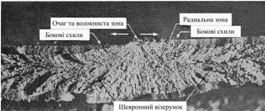
Рисунок 4.4 – Визначення центру руйнації за видом зламу. Радіальні рубці нижче центру руйнації і шевронний візерунок ліворуч і праворуч визначають напрям розповсюдження тріщини
