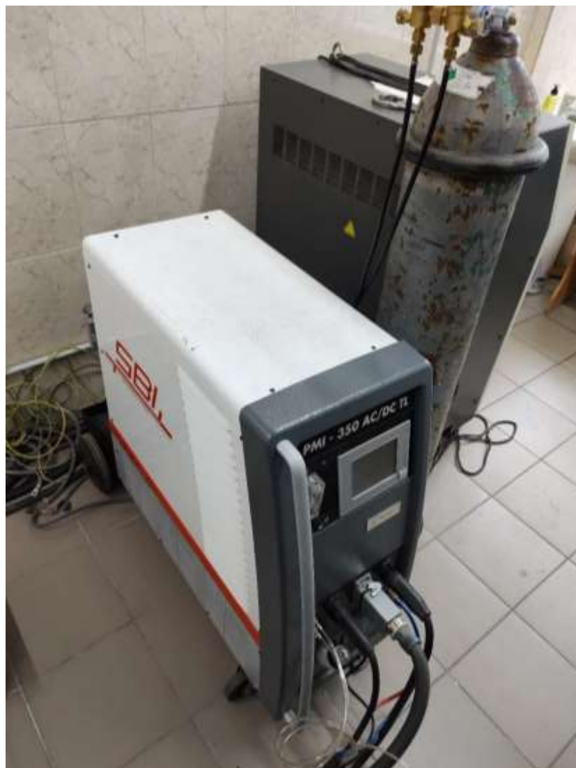
Рисунок 4.6 Джерело живлення SBI PMI 350 AC/DC
