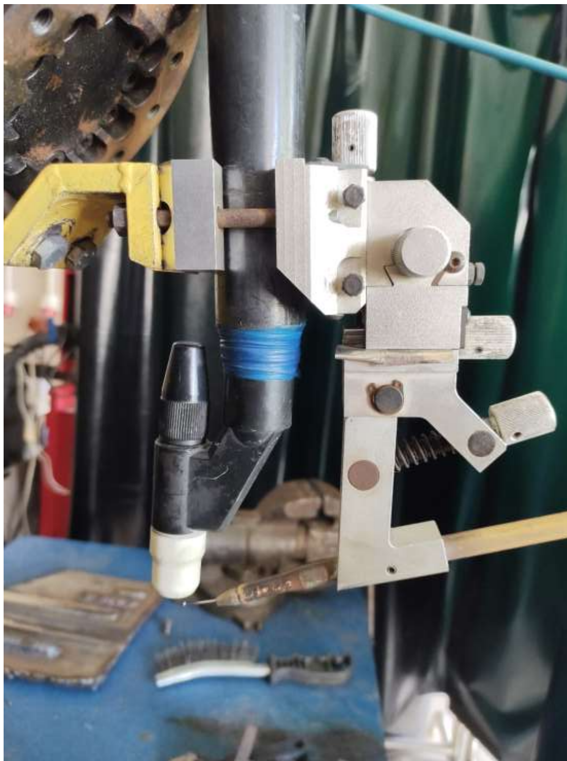
Рисунок 4.4 – Плазмовий пальник ТР 200-R
