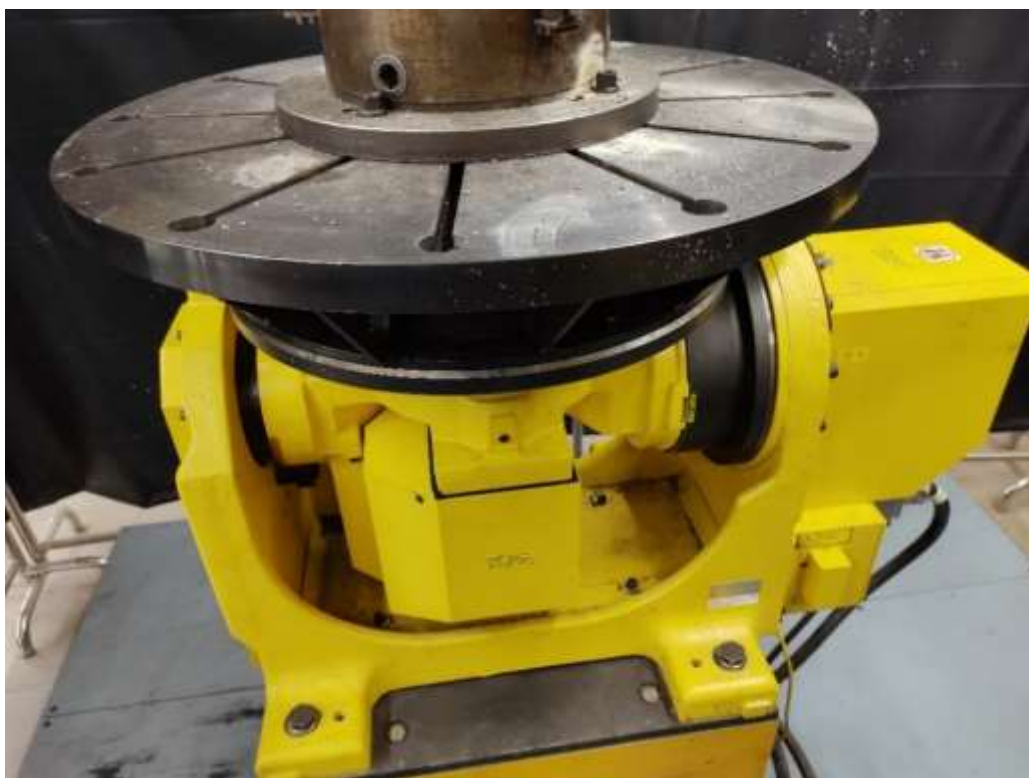
Рисунок 4.3 Маніпулятор FANUC a iS 8/4000
