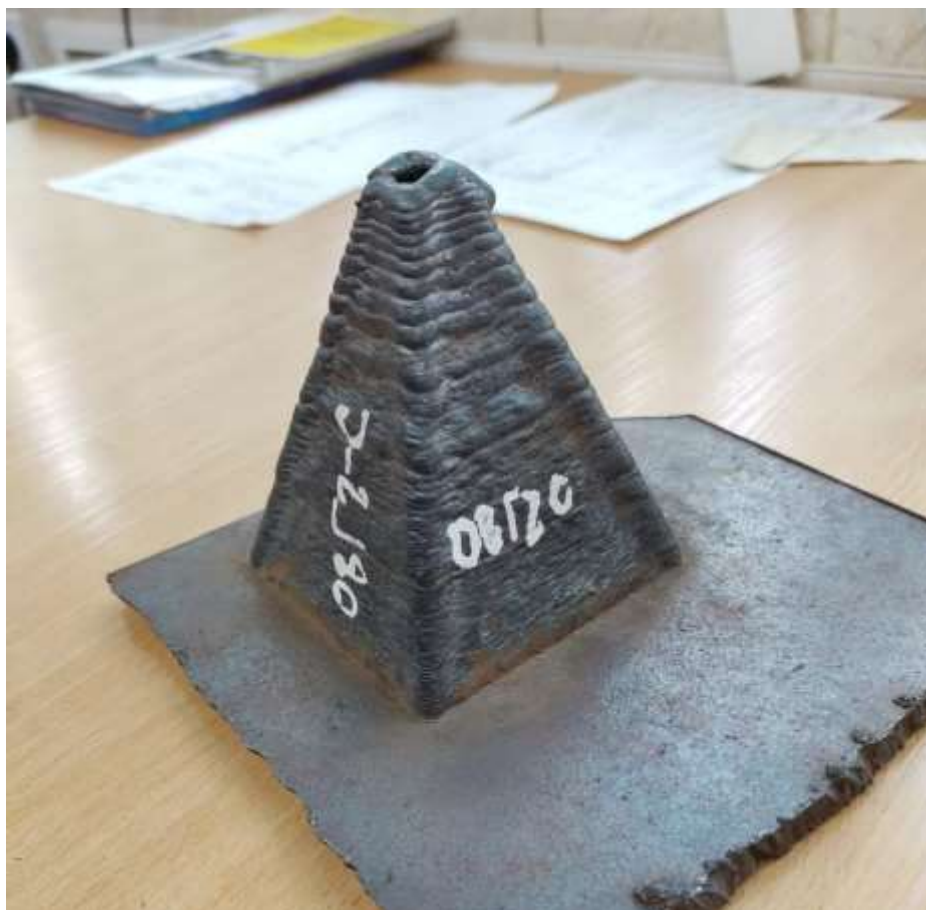
Рисунок 3.4 вирощена піраміда із дроту СВ08Г2С, за технологію WAAM
