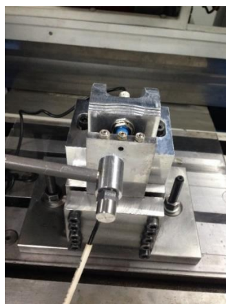
Рисунок 4.5 – Збурення за допомогою ударника із акселерометром ДН-4-М1
