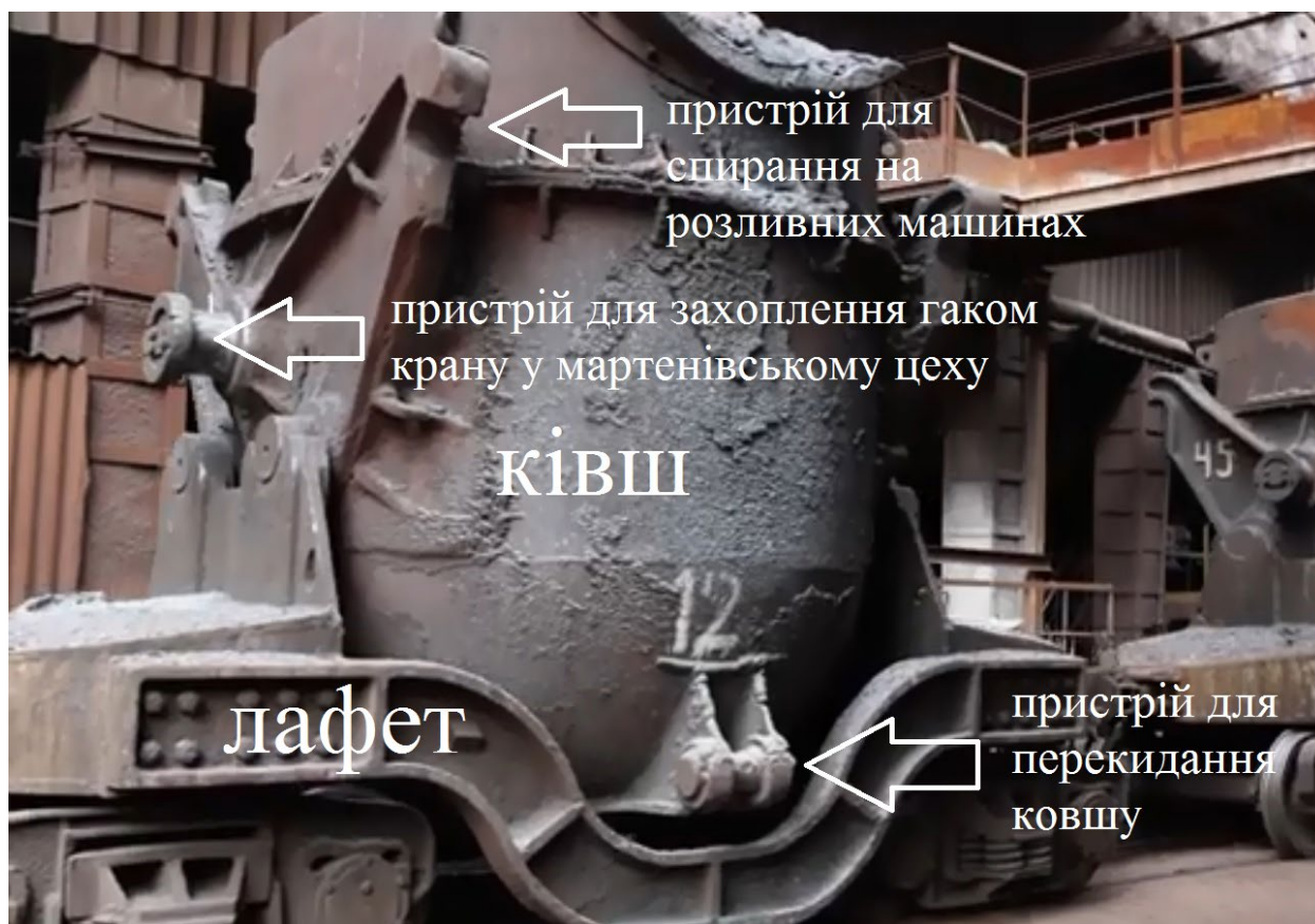
Рисунок 1.3 – Устрій чавуновозу
