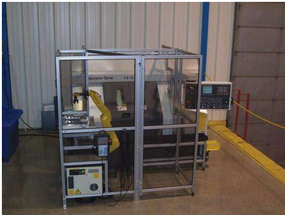
Рисунок 3.1 – Технічні засоби автоматизації та механізації токарного верстата
