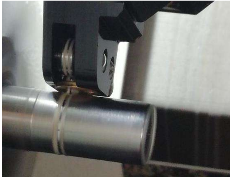
Рисунок 5.1 – Поверхнєве пластичне деформування обкаткою роликми [13]
