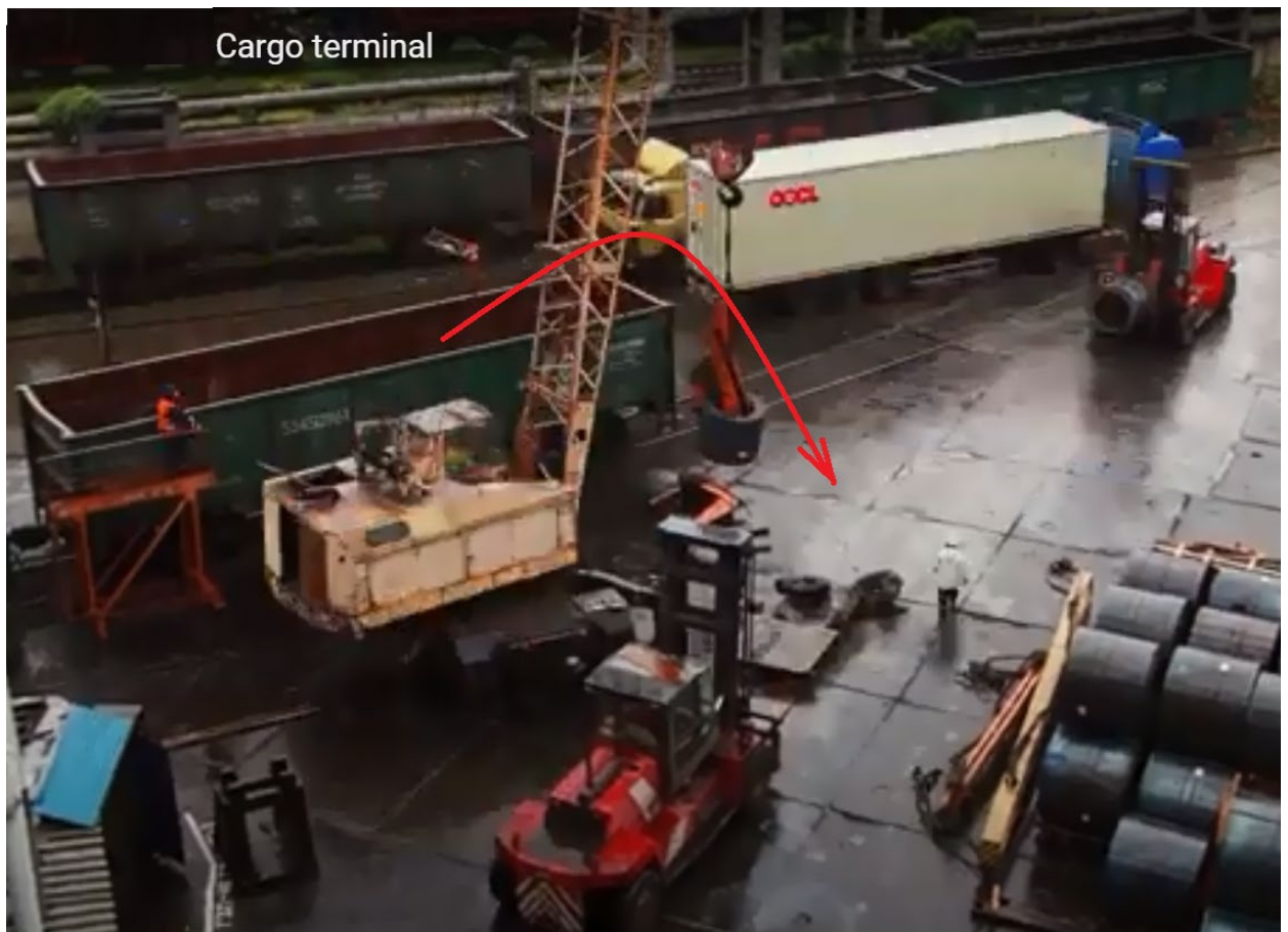
Рисунок 1.8 – Розвантаження прокату в умовах Бруклін-Київ за допомогою кліщів
