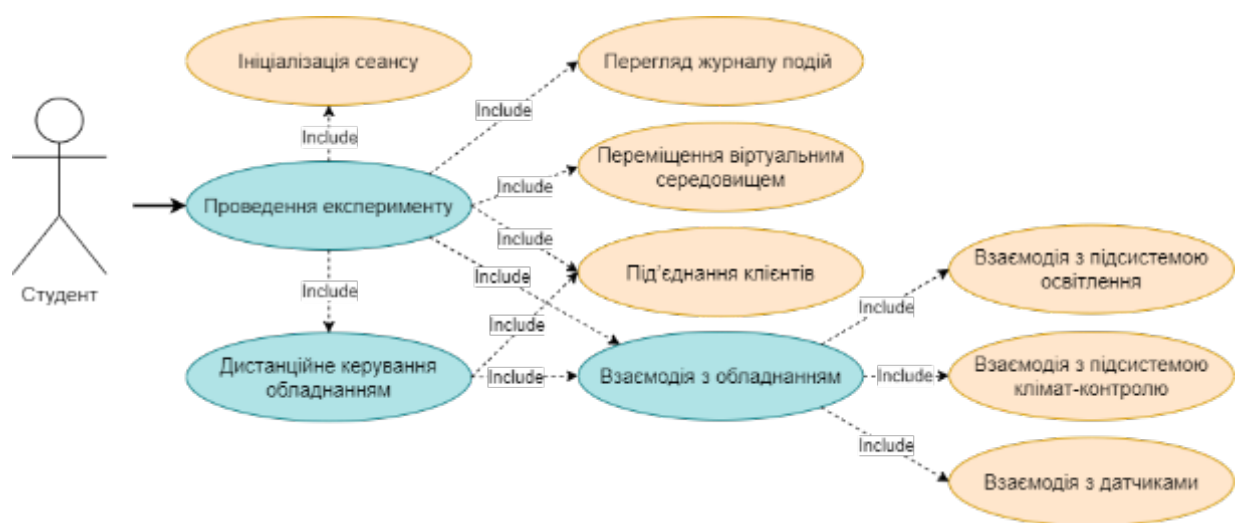
Рисунок 3.2 – Діаграма прецедентів для процесу взаємодії користувача з розроблюваним віртуальним середовищем
