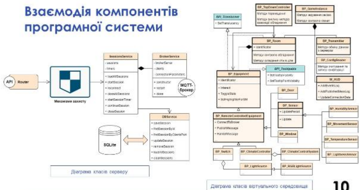
Рисунок Б.10 – Взаємодія компонентів програмної системи
