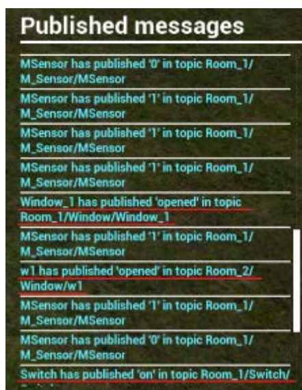
Рисунок 5.5 – Журнал опублікованих повідомлень, у якому можна знайти теми та команди, які використовує обладнання
