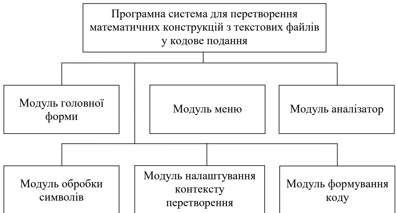
Рисунок 3.1 – Структура програмної системи для перетворення математичних конструкцій з текстових файлів у кодове подання
