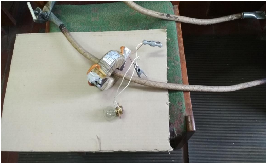
Рисунок 4.2 – Під'єднана автомобільна лампа до трансформатора струму
