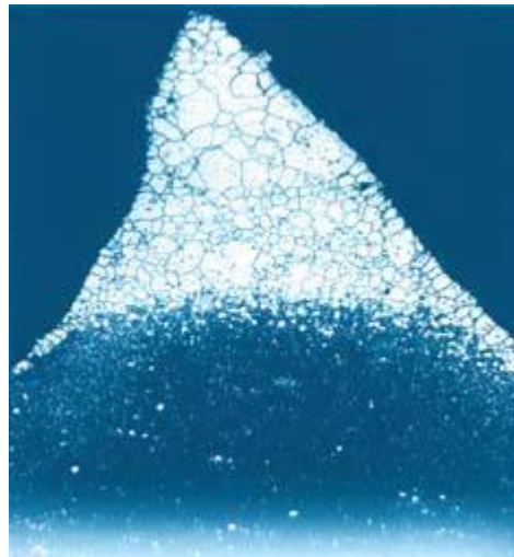
Рисунок 4.4 – Структура ділянки інструменту з сильним знеуглецюванням поверхневого шару і яскраво вираженою різнозернистістю (світла область)
