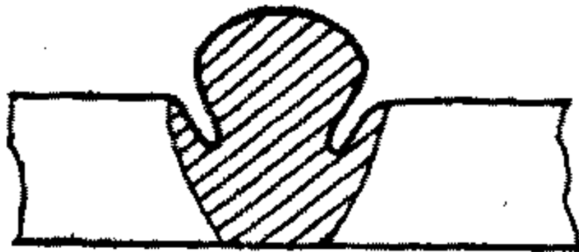
Рисунок 2.11 – Зона несплавлення в зварному шві
