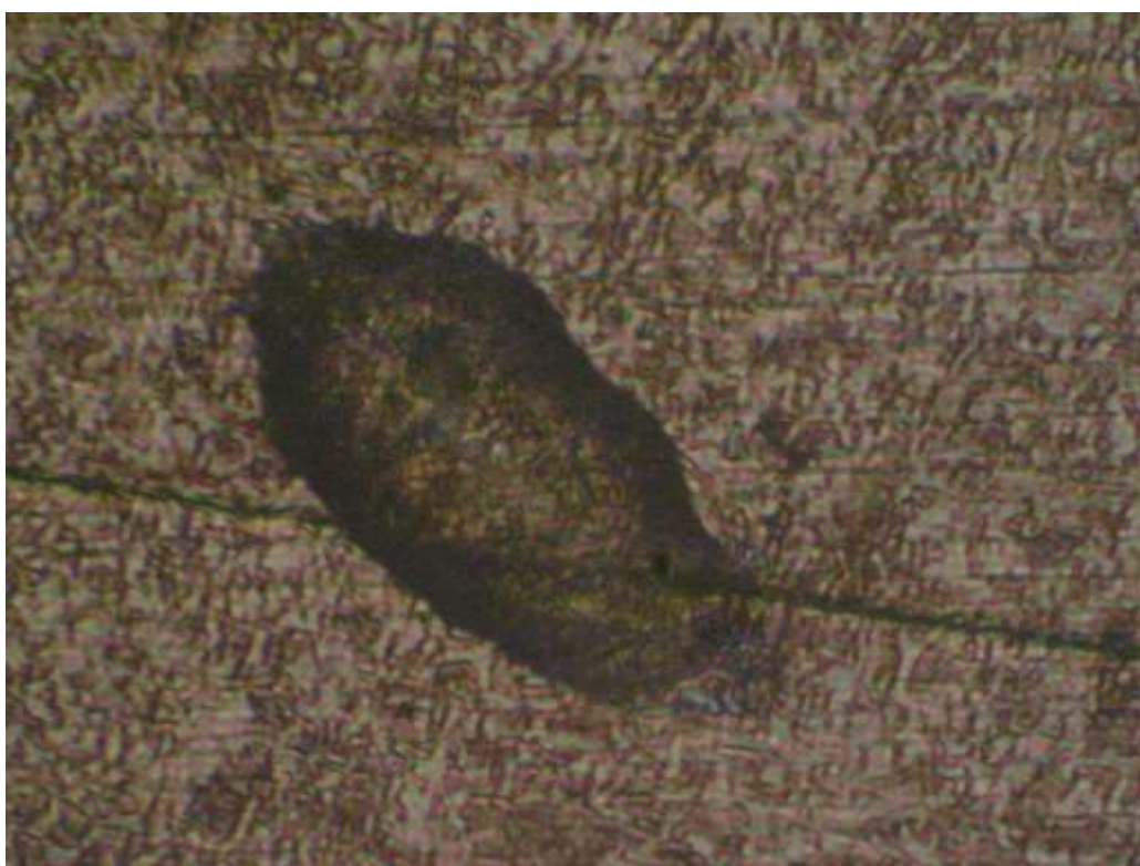
Рисунок 5.3 – Мікроструктура металу зварного шва з дефектом
