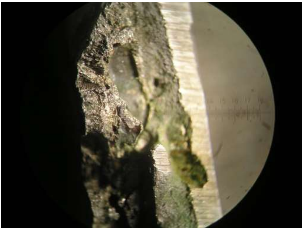
Рисунок 5.4 – Макроструктура зламу зварного шва з дефектом
