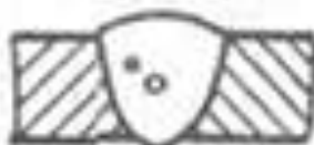
Рисунок 2.3 – Пори в зварному шві
