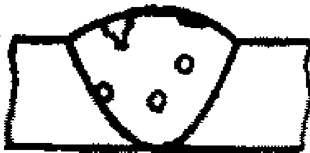
Рисунок 2.3 – Пори в зварному шві
