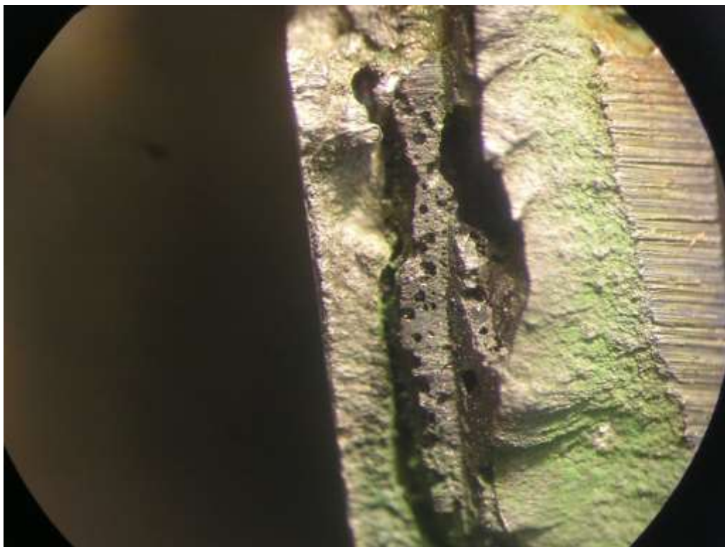
Рисунок 5.5 – Макроструктура зламу зварного шва з дефектом
