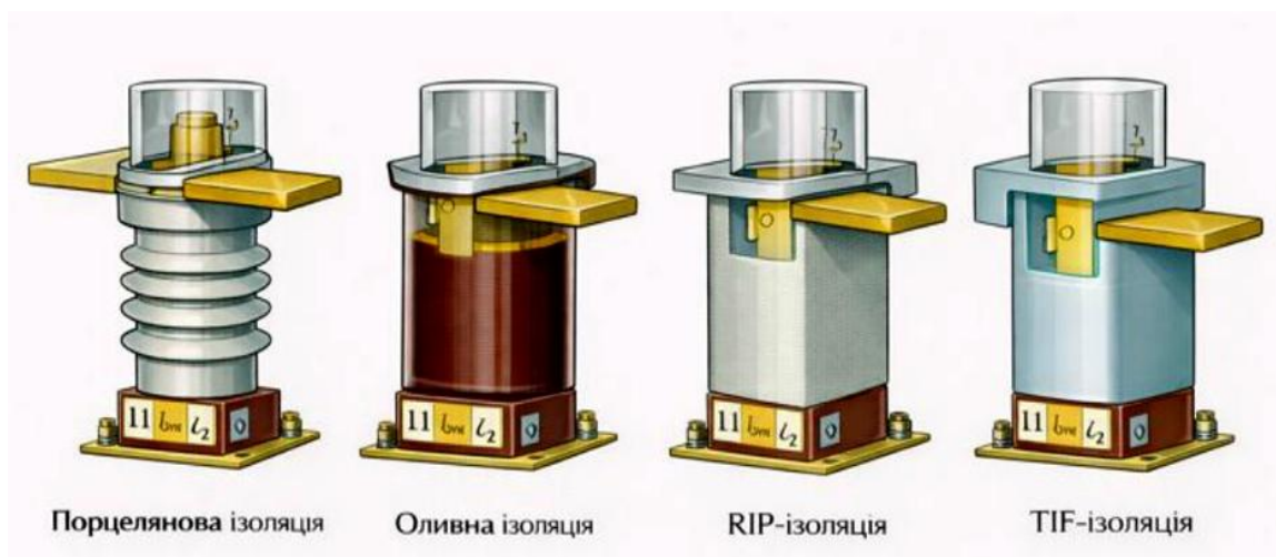
Рисунок 1.4 - Шинні вбудовані трансформатори струму
