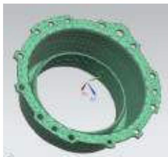
Рисунок 4.1 – Математична модель деталі розбита на сітку кінцевих елементів
