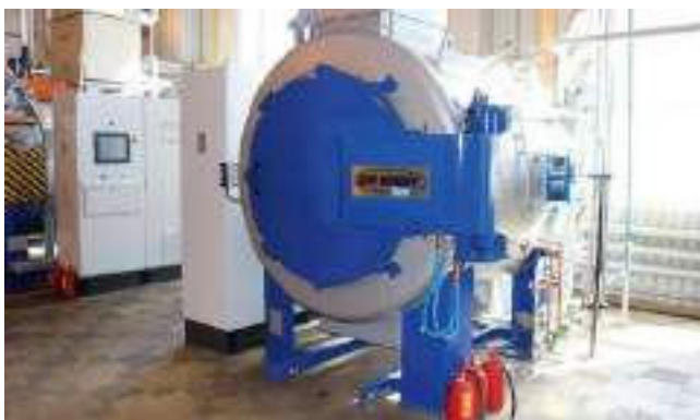
Рисунок 5.3 – Вакуумна піч для термічної обробки з системою газового азотування
