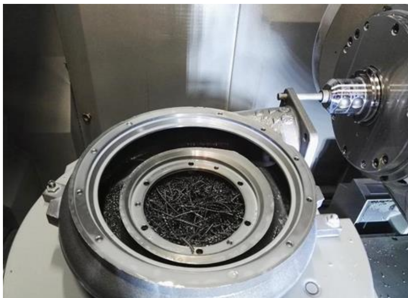
Рисунок 1.2 – Приклад обробки поверхні, яка знаходиться з протилежного боку від шпинделя верстата
