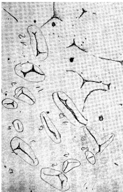
Рисунок 6.13 – Вкраплення фосфідної евтектики в високомарганцевій сталі
