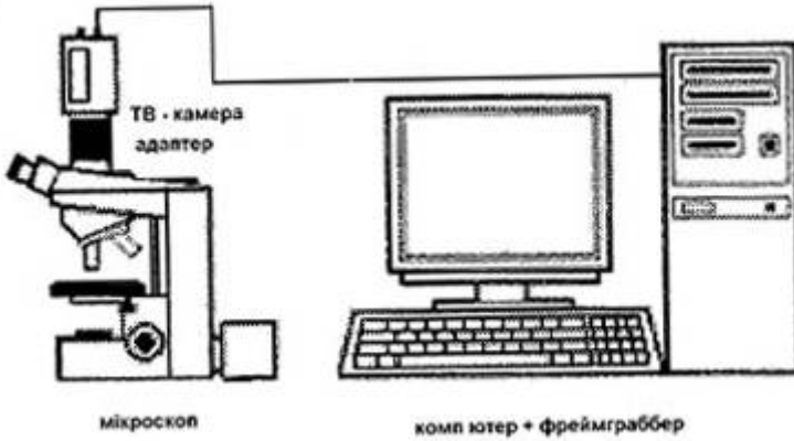
Рисунок 6.27 – Схема цифрового мікроскопу
