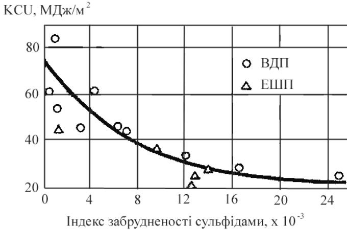
Рисунок 6.31 – Вплив сульфідних вкраплень на ударну в'язкість висококомірної сталі
