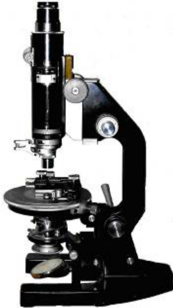
Рисунок 6.16 – Поляризаційний мікроскоп МИН-4
