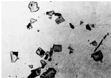
Рисунок 6.9 – Сульфідні вкраплення в сталі, розкисленій алюмінієм (0,1 %)
