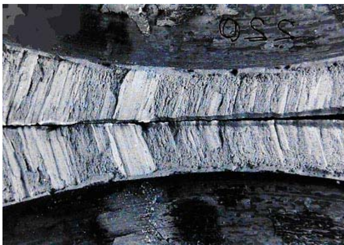
Рисунок 6.35 – Дефект макрозламу, викликаний плівчастими нітридами алюмінію
