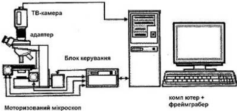
Рисунок 6.28 – Схема автоматизованого мікроскопу
