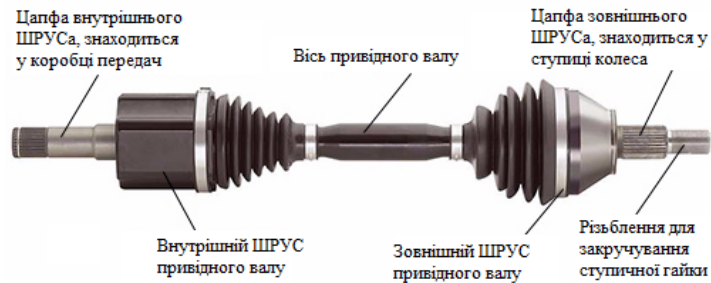
Рисунок А.1 – Конструкція напіввісі автомобілю
