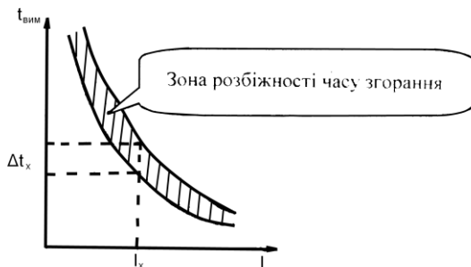
Рисунок 3.1 – Захисна характеристика запобіжника
