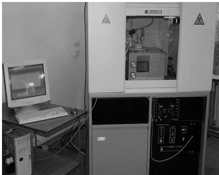
Рисунок 2.3.-Рентгенівський дифрактометр ДРОН-6
