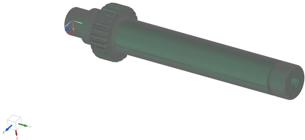
Рисунок 2.6 – Розбиття деталі на кінцеві елементи
