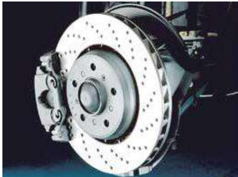
Рисунок 2.6 – Дискове гальмо з вентильованим гальмівним диском
