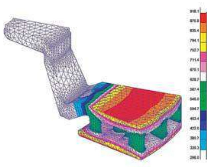
Рисунок 2.8 – Дія теплового поля у гальмівному диску
