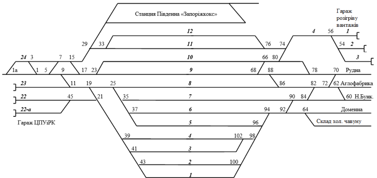
Рисунок 1.4 – Схема колійного розвитку станції Південна Південного залізничного району
