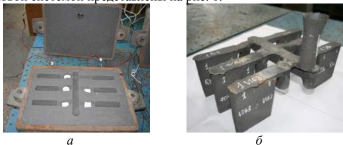
Рисунок 1 – Внешний вид литейной формы (а) и блока экспериментальных отливок с литниковой системой (б)
