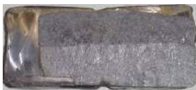
Рисунок 1 – Макроструктура зламу двошарового виливка
