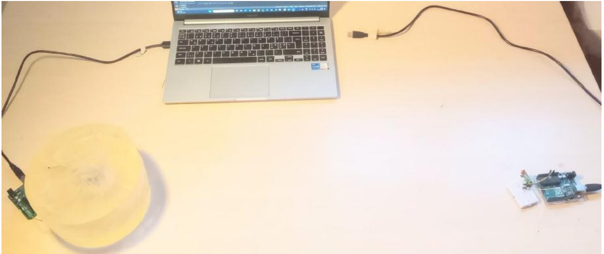
Рисунок 2.13 – Передавач 433 МГц у балістичному гелі та налаштування вимірювання
