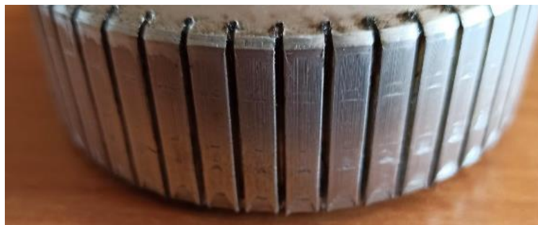
Рисунок 4.5 – Фотографія отриманих пазів за допомогою видавлювання
