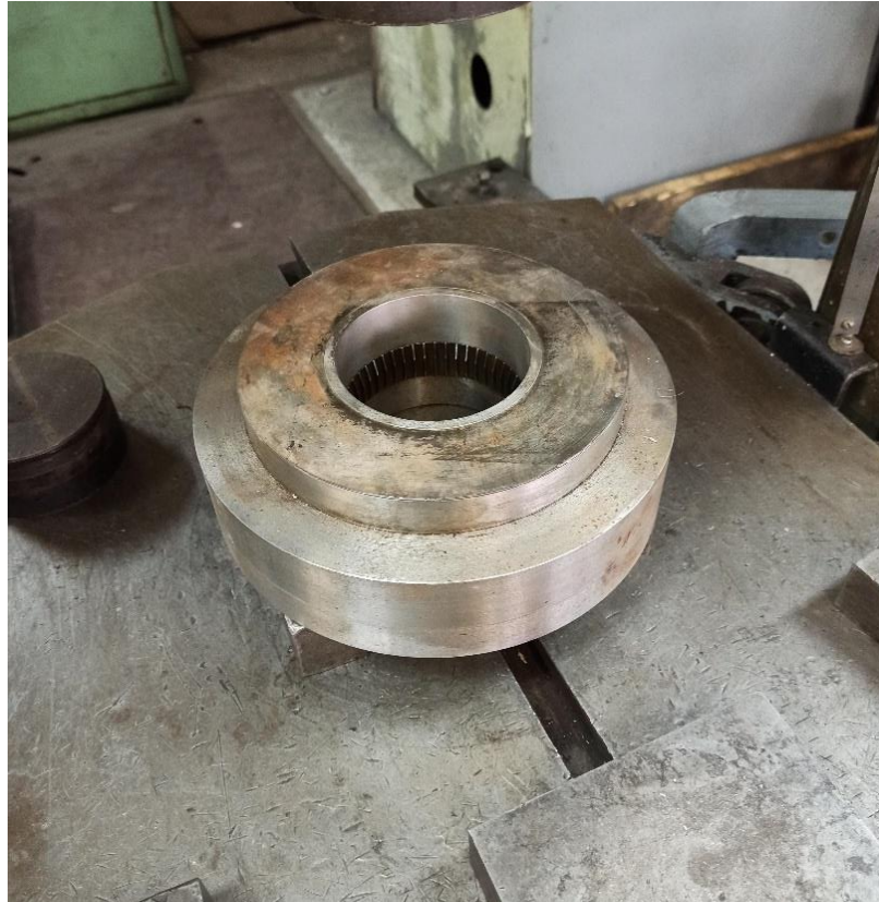
Рисунок 3.4 – Експериментальна матриця встановлена на пресі
