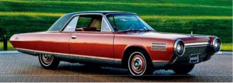
Рисунок 10.2 – Chrysler Turbine це єдиний у світі газотурбінний легковий автомобіль, який був випущений невеликою серією.
