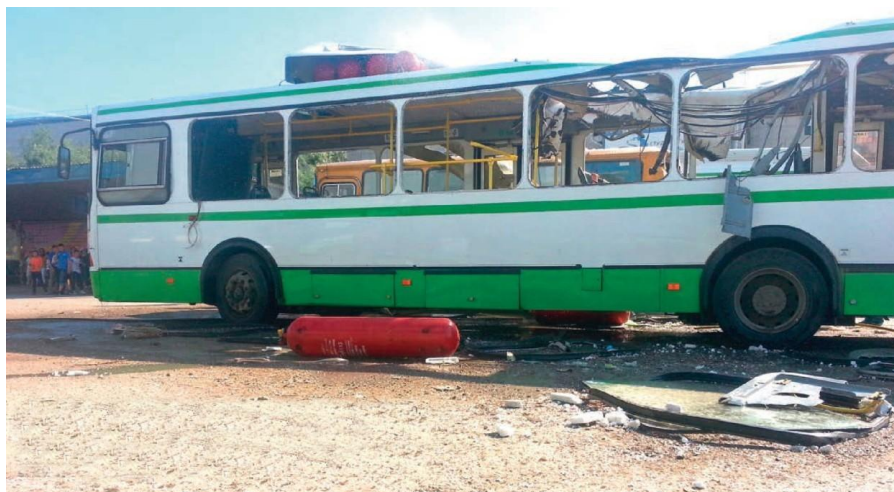
Рисунок 8.13 - Розрив сталюого газового балону
