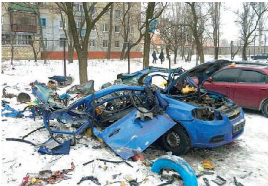
Рисунок 8.12 – Наслідки розриву композитного метанового балону
