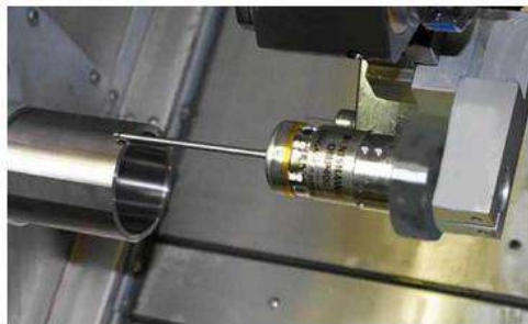
Рисунок 3.1 – Контроль розміру деталі на верстаті
