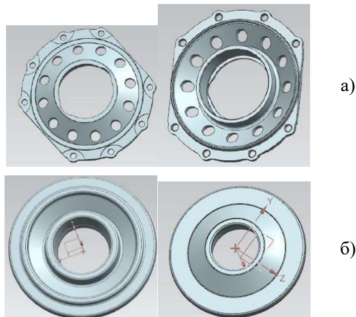
Рисунок 1.15 – 3D-моделі (а – деталь; б – заготовка)
