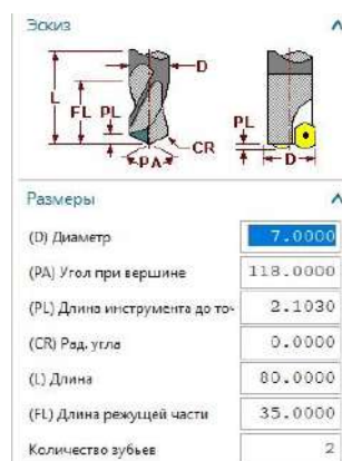
Рисунок 1.20 – Інструмент та його параметри (а – перший перехід; б – другий перехід)
