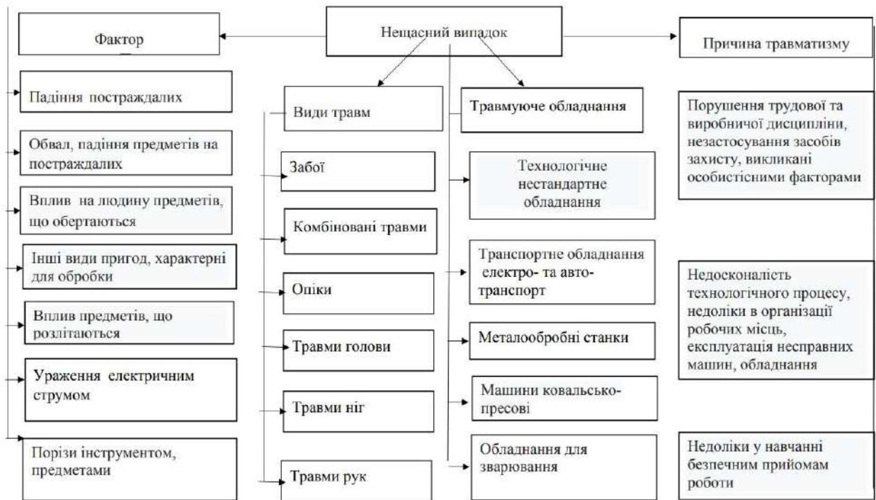
Рисунок 7.1 – Комплексна схема потенційних небезпек, характерних для технологічного процесу на механічній дільниці
