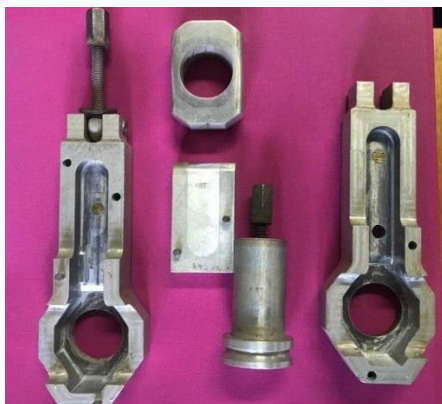
Рисунок 7.6 – Прес-форми для виготовлення пінополістиролових моделей ванним та автоклавним способами
