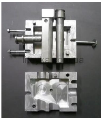
Рисунок 7.6 – Прес-форми для виготовлення пінополістиролових моделей ванним та автоклавним способами
