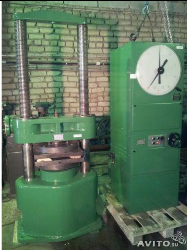
Рисунок 2.4 – Загальний вид гідравлічного пресу ПГ-100А
