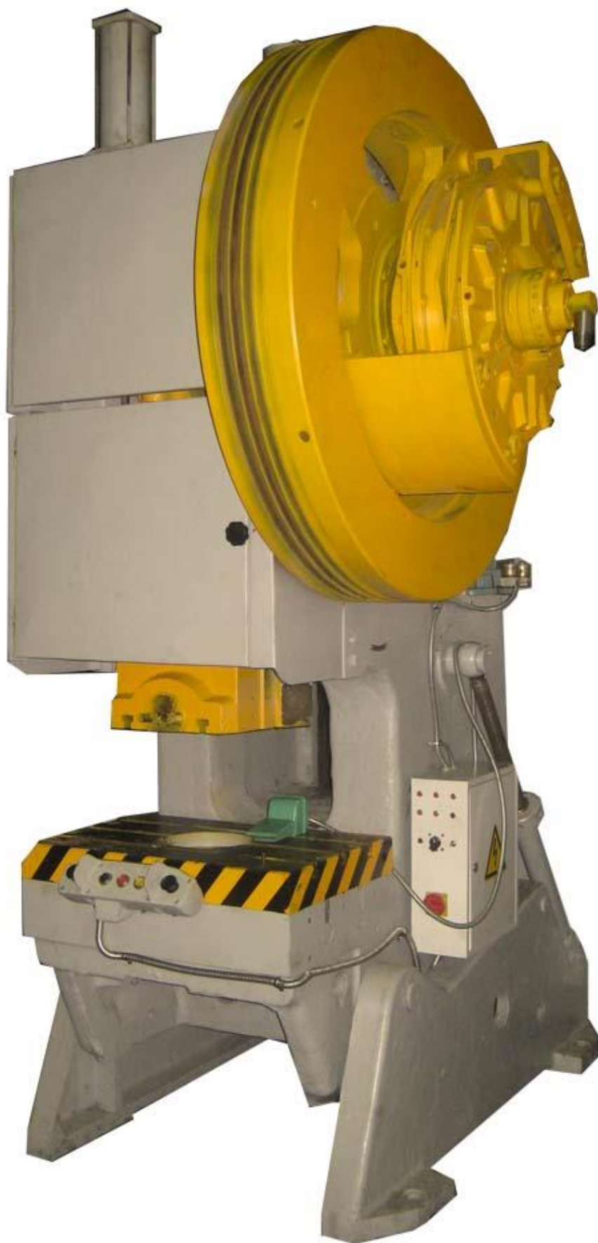
Рисунок 2.2 – Загальний вид однокривошипного преса КА2330
