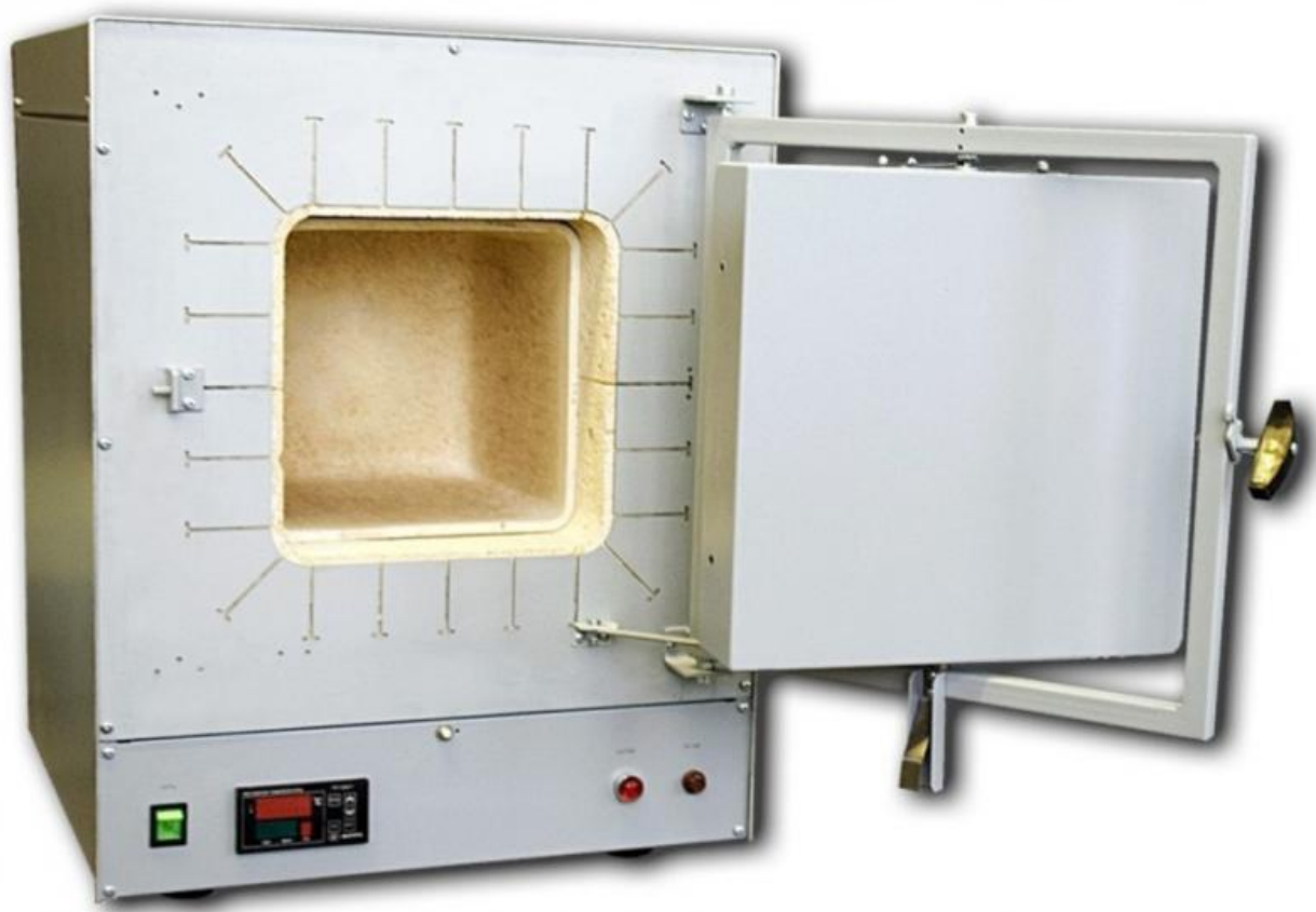
Рисунок 2.12 – Лабораторна муфельна піч ПМ
