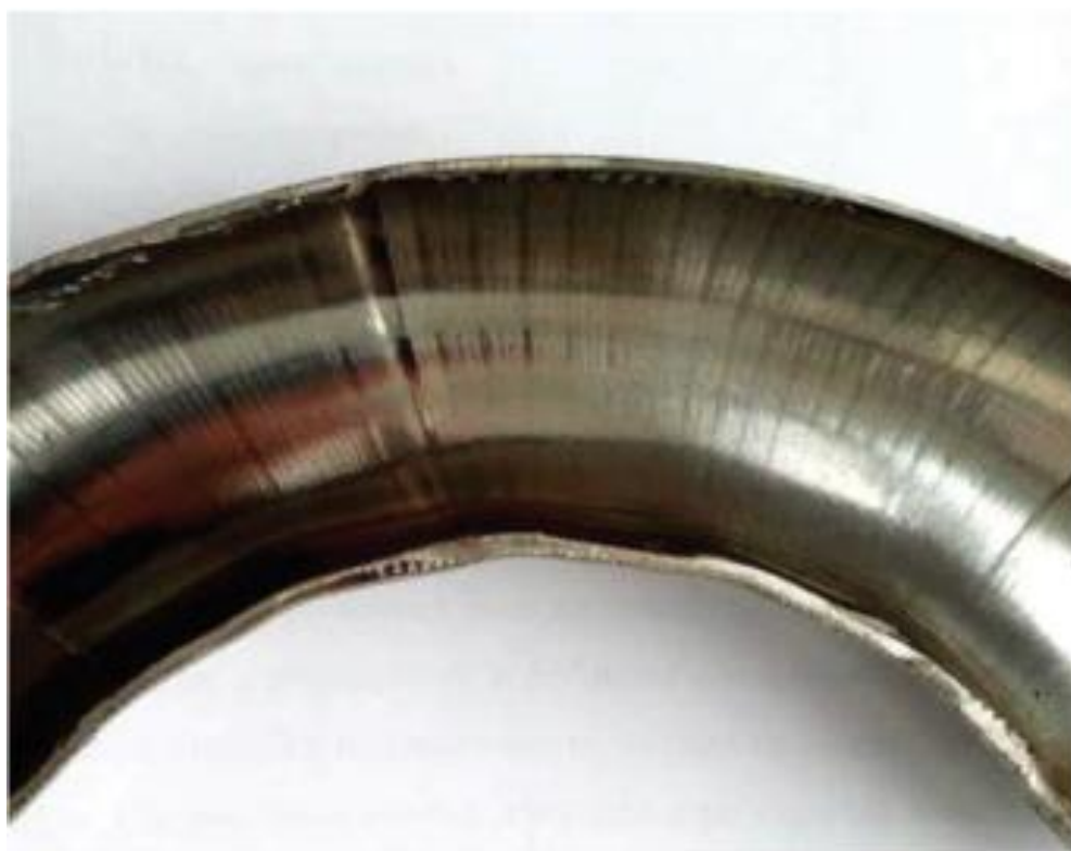
Рисунок 3.7 - Зображення труби після згинання в розрізі
