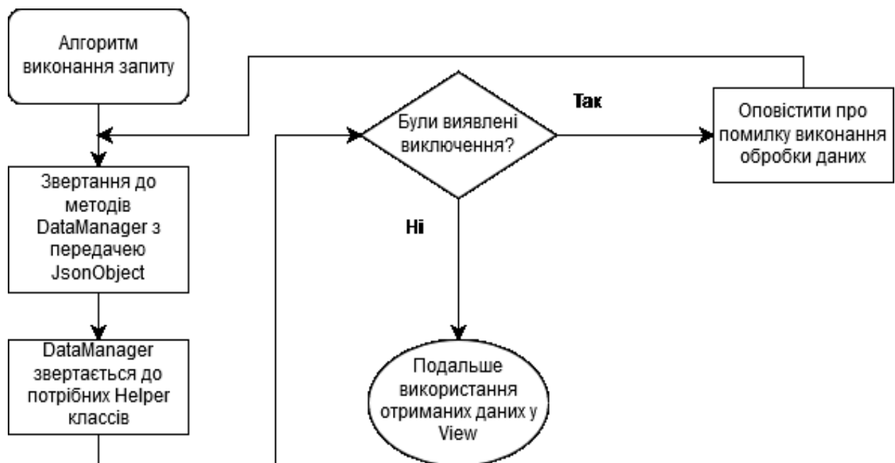
Рисунок 3.5 – Функціональна схема алгоритму обробки отриманих даних
