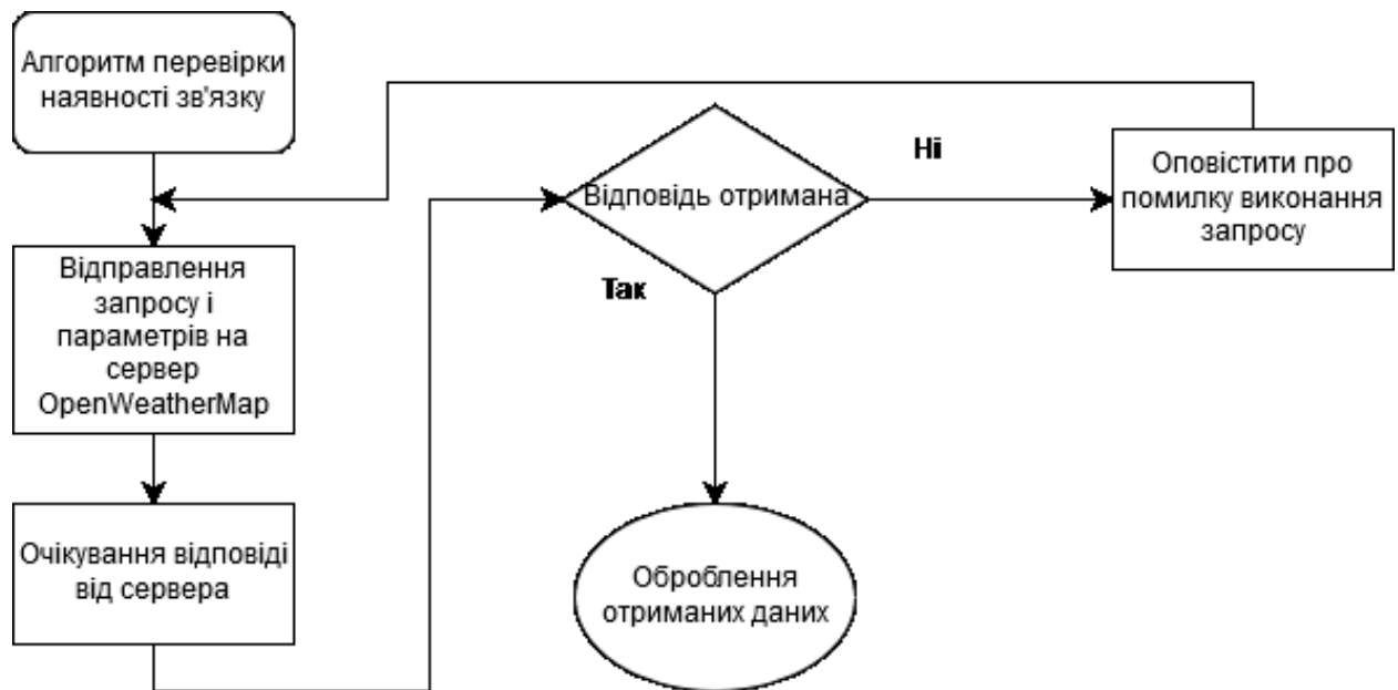
Рисунок 3.4 – Функціональна схема алгоритму виконання запиту до серверу
