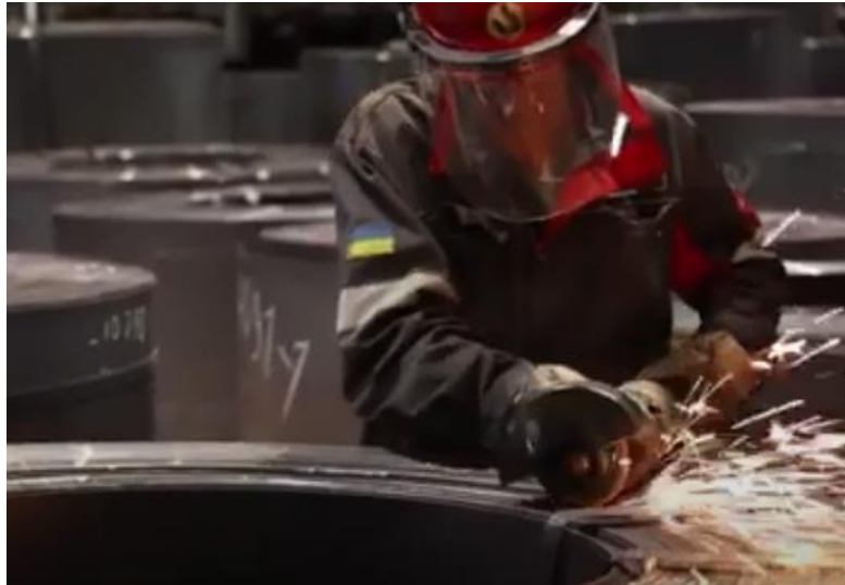
Рисунок 1.6 – Обробка торців стрічки прокату в ЦГПТЛ
