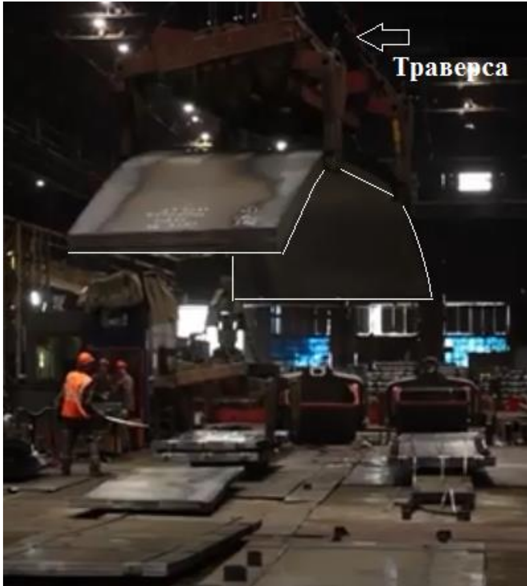
Рисунок 1.4 – Переміщення пачок гарячого металопрокату за допомогою траверс в ЦГПТЛ
