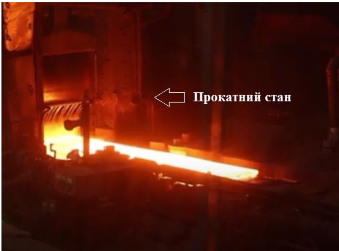
Рисунок 1.1 – Процес прокатки гарячого листа у ЦГПТЛ
