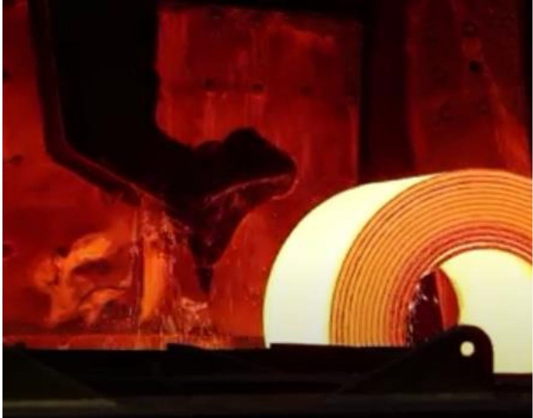
Рисунок 1.2 – Процес формування рулону гарячого листа
