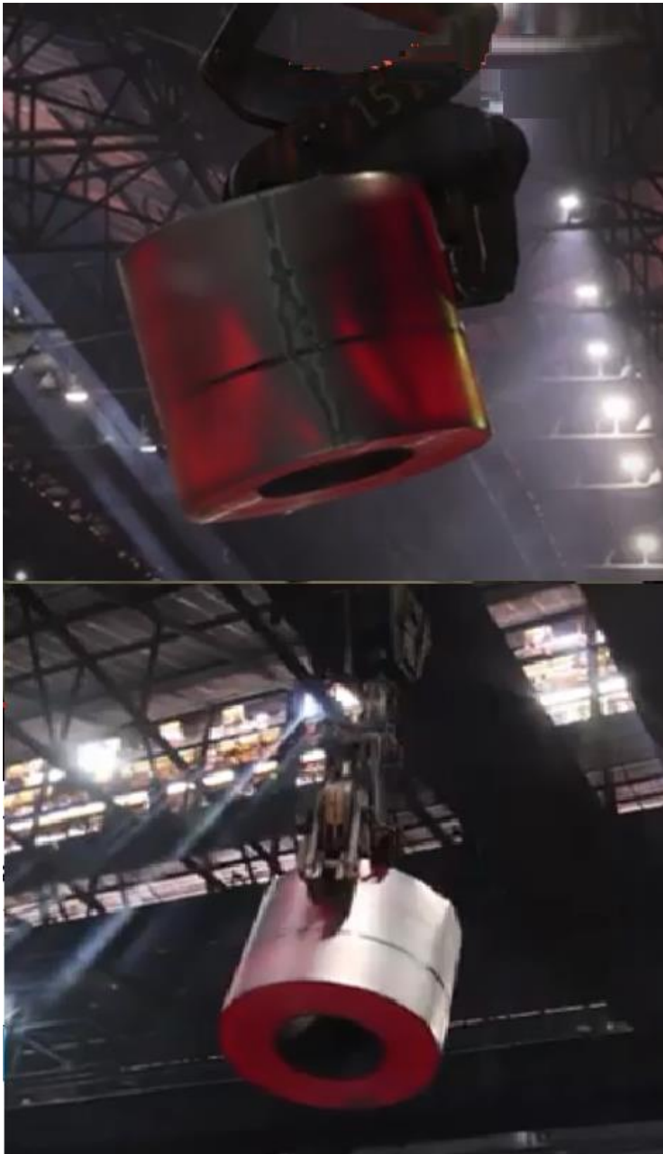
Рисунок 1.3 – Переміщення рулонів гарячого металопрокату за допомогою кліщового захвату в ЦГПТЛ
