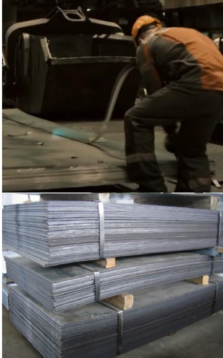
Рисунок 1.5 – Пакування гарячого металопрокату в ЦГПТЛ
