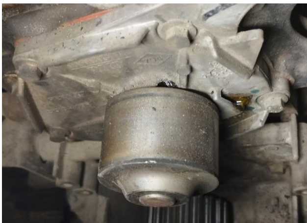
Рисунок 1 – Водяний насос зі слідами витіканням охолоджуючої рідини через дренажні отвори
