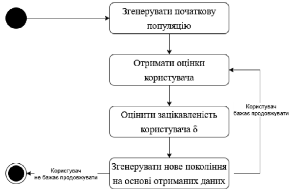
UML-діаграма схеми роботи алгоритму
