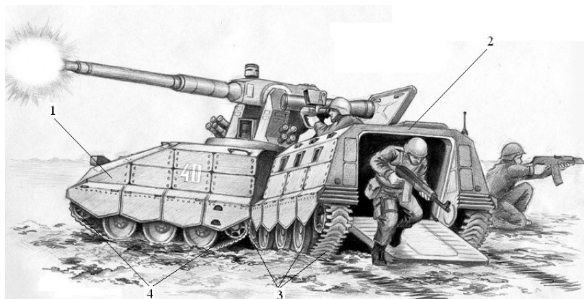
Рисунок 7.1 – Загальний вигляд дволанкової тяжкої гусеничної бойової машини
