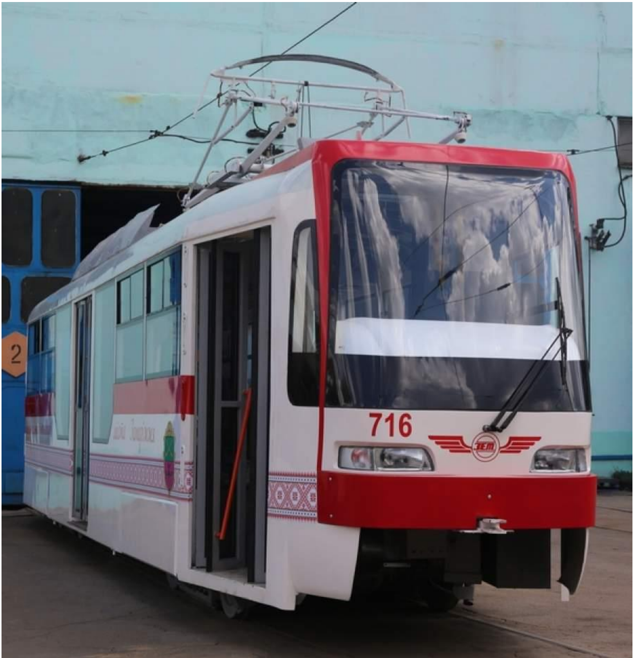
Рисунок 1.11 — Зовнішній вигляд трамвайного вагону Tatra T3UAKBVP
