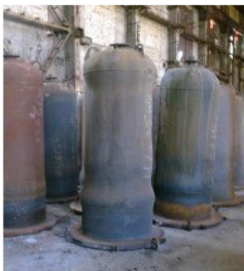
Рисунок 1 – Реторти (реактори) магнійтермічного виробництва титану
