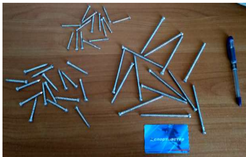
Рисунок 3.9 - Експериментальні гвинти зі сплаву MC10, виготовлені в умовах АТ «Мотор Січ»
